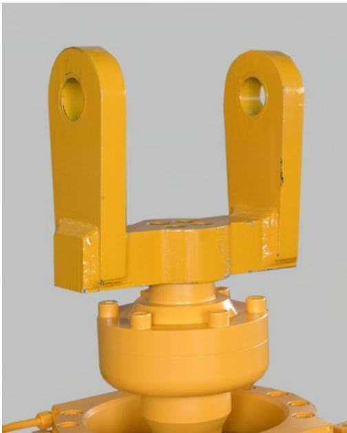
Montieren Sie das Schwenklager mit 4 Innensechskantschrauben auf den Schwenklageranschluss.
