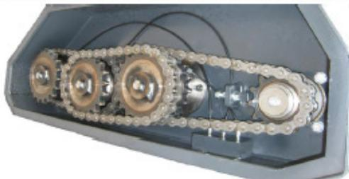
Antriebsketten von Siebschaufeln mit Doppelantrieb müssen kongruent geregelt werden, so dass sie gleichmäßig ziehen. Zur Regulierung werden die Schraubbolzen des Montagebodens des Hydraulikmotors gelöst und der Motor nach rechts verschoben (Spielraum 0 - 3 mm, wenn es sich um eine neue Kette handelt). Die Schrauben des Montagebodens müssen danach mit einem Momentschlüssel festgezogen werden, womit man sich von der Haltbarkeit der Einstellung überzeugt.
