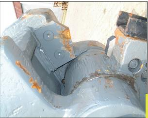
Spezialschere bzw. Schienenknacker zum Brechen u. Zerschneiden von Eisenbahnschienen.
