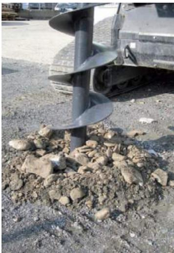
Schnell und einfach Bohrungen bis zu 1400 mm durchführen für Bagger von 1 – 38 t Dienstgewicht spart Personal und erhöht die Leistung Bohrer in unterschiedlichen Durchmessern einsetzbar mit Verlängerungen für große Tiefen geeignet Schwenkadapter
