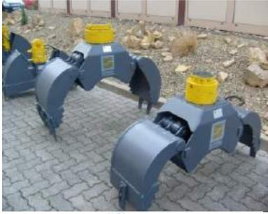
**Mehrzweckgreifer** können für die unterschiedlichsten Arbeiten eingesetzt werden. Beinahe alles kann mit dem Greifer gepackt, versetzt, sortiert oder platziert werden. Durch den robusten Aufbau und seine überragende Wendigkeit bietet er ungeahnte Möglichkeiten. Eingebaute Druckhalteventile ermöglichen ein sauberes und feinfühliges Arbeiten auch unter schwierigen Bedingungen. Darüber hinaus findet er in gleicher Weise für Erdaushub und Verladearbeiten immer neue Freunde.
