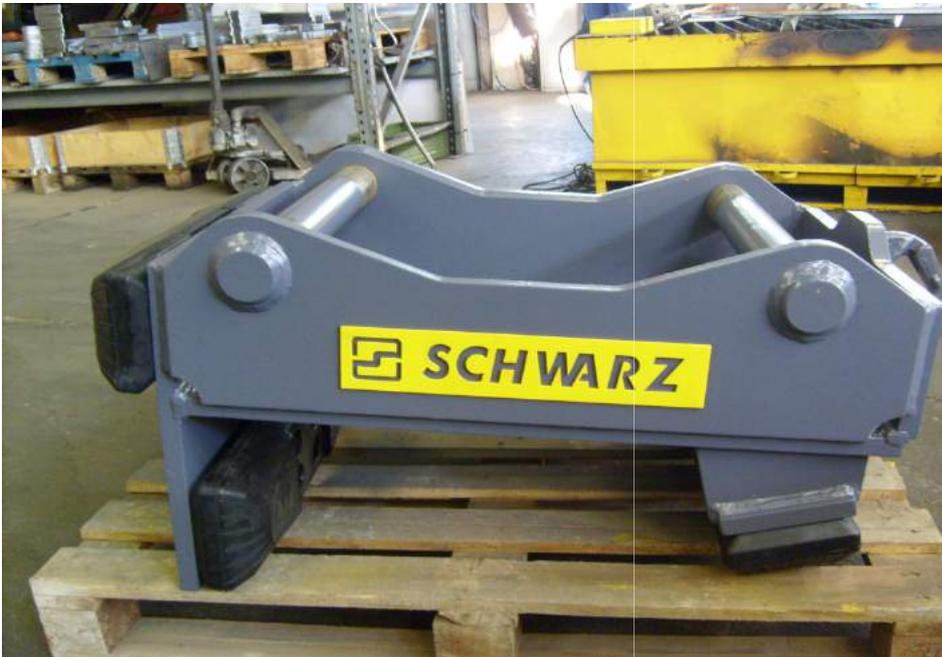
Rohrschiebeadapter mit Gummiplatte Stirn und Bodenplatte. Zusätzlich mit lang geführter Stirnplatte. Bild Links und unten rechts.
