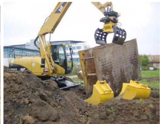
Handarbeit entfällt fast völlig, jeder Winkel kann jetzt bearbeitet werden. Fahrtätigkeit wird reduziert, das schont Fahrwerk und Gummiketten. Gleichzeitig wird die Leistung gesteigert. Werkzeugwechsel erfolgt im Sekundentakt. Hydraulische Werkzeuge wie Greifer, Verdichterplatte, Astschere, Mulcher können verwendet werden, benötigen aber keinen eigenen Drehkranz. Alle Werkzeuge sind jetzt dreh- und schwenkbar.
