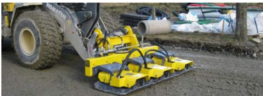
mehrfach Verdichterplatten für Radlader, Walzen und Grader im Fronteinsatz & als Nachläufer.
