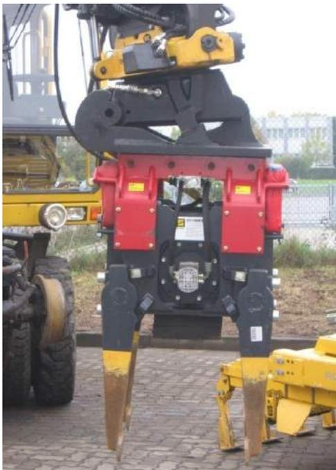
Die Vibrationseinheit kann wahlweise für das Stopfaggregat (A) oder als Verdichterplatte (B) eingesetzt werden.
