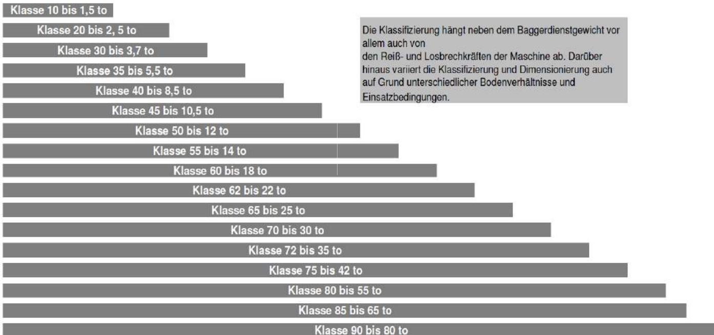
Die Klassifizierung hängt neben dem Baggerdienstgewicht vor allem auch von den Reiß- und Losbrechkraften der Maschine ab. Darüber hinaus variiert die Klassifizierung und Dimensionierung auch auf Grund unterschiedlicher Bodenverhältnisse und Einsatzbedingungen.
