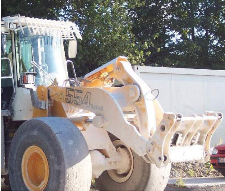
Schnellwechsler für Radlader. Kuppeln von einem oder mehreren hydraulischen Kreisen.
