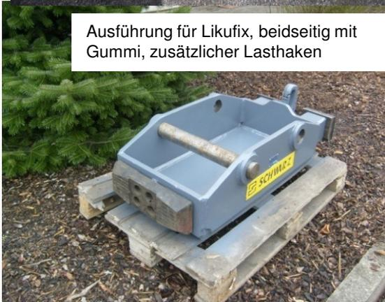
Ausführung für Likufix, beidseitig mit Gummi, zusätzlicher Lasthaken
